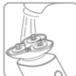
4. Промойте отсек для усов водой или почистите щеткой для чистки.
