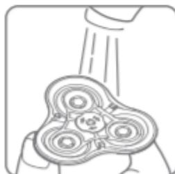
5. Промойте держатель бритвенной головки водой (рекомендуется использовать теплую воду, не используйте полотенце или салфетку для протирки бритвенной головки).
