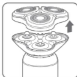
3. Снимите держатель бритвенной головки, потянув его в сторону от электробритвы.
