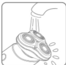
2. Промойте бритвенную головку водой (рекомендуется использовать теплую воду).
